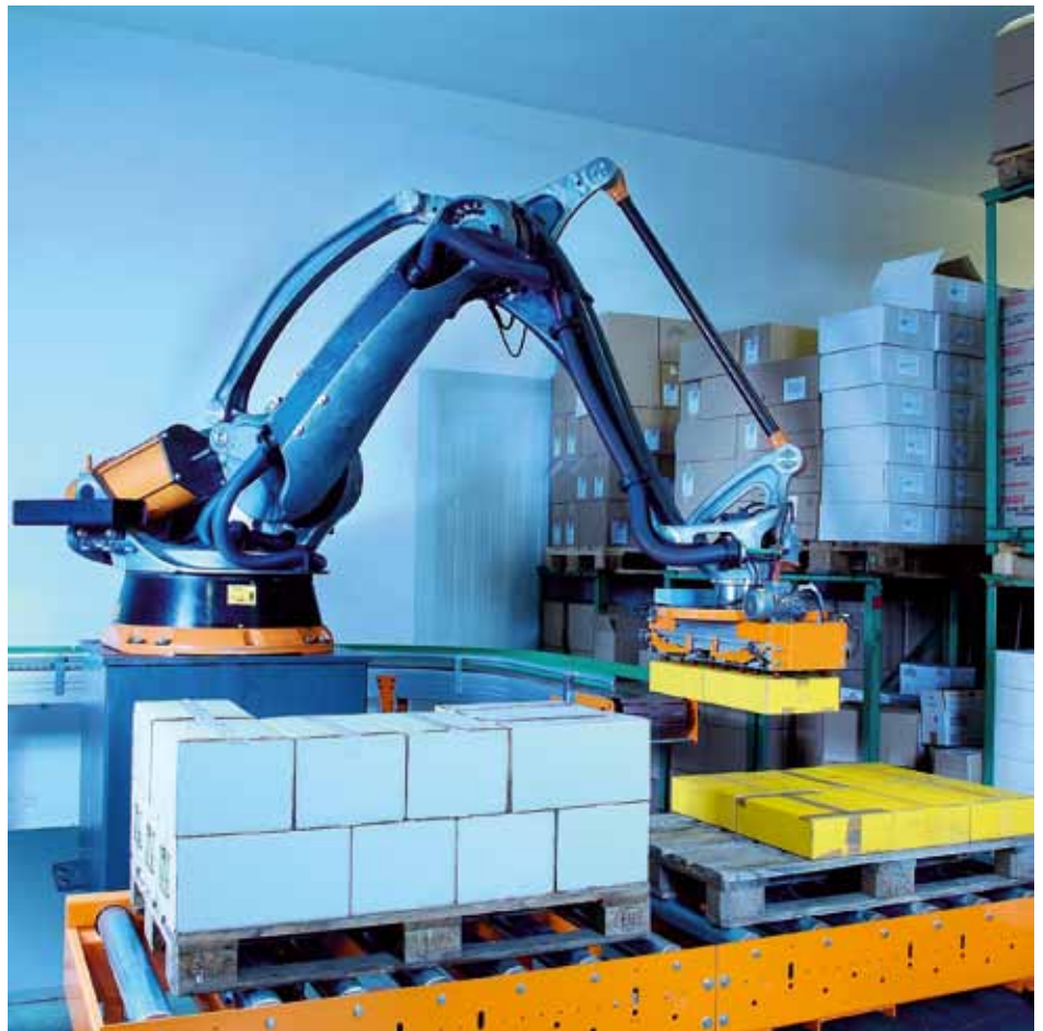
Die Roboter-Palettieranlage erreicht eine Gesamtleistung von 840 Kartons oder Faltschachteln beziehungsweise 17,5 Paletten in der Stunde.
