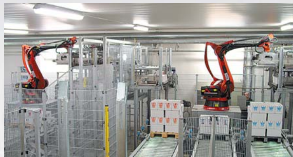
К примеру полностью автоматизированный центр палетирования молочных трей-упаковок с подвязкой своей системы учёта продукции к системе SAP-R/3-клиента.
