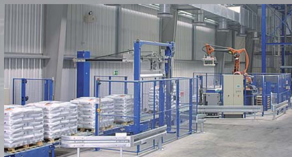
К примеру комплексная линия по фасовке и палетированию мешков производительностью 1000 мешков в час.
